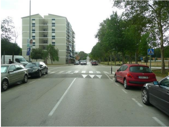
Imatge 103. Zona prèvia al sud, amb zebra abans del pas per a evitar l'aparcament just abans del pas.
